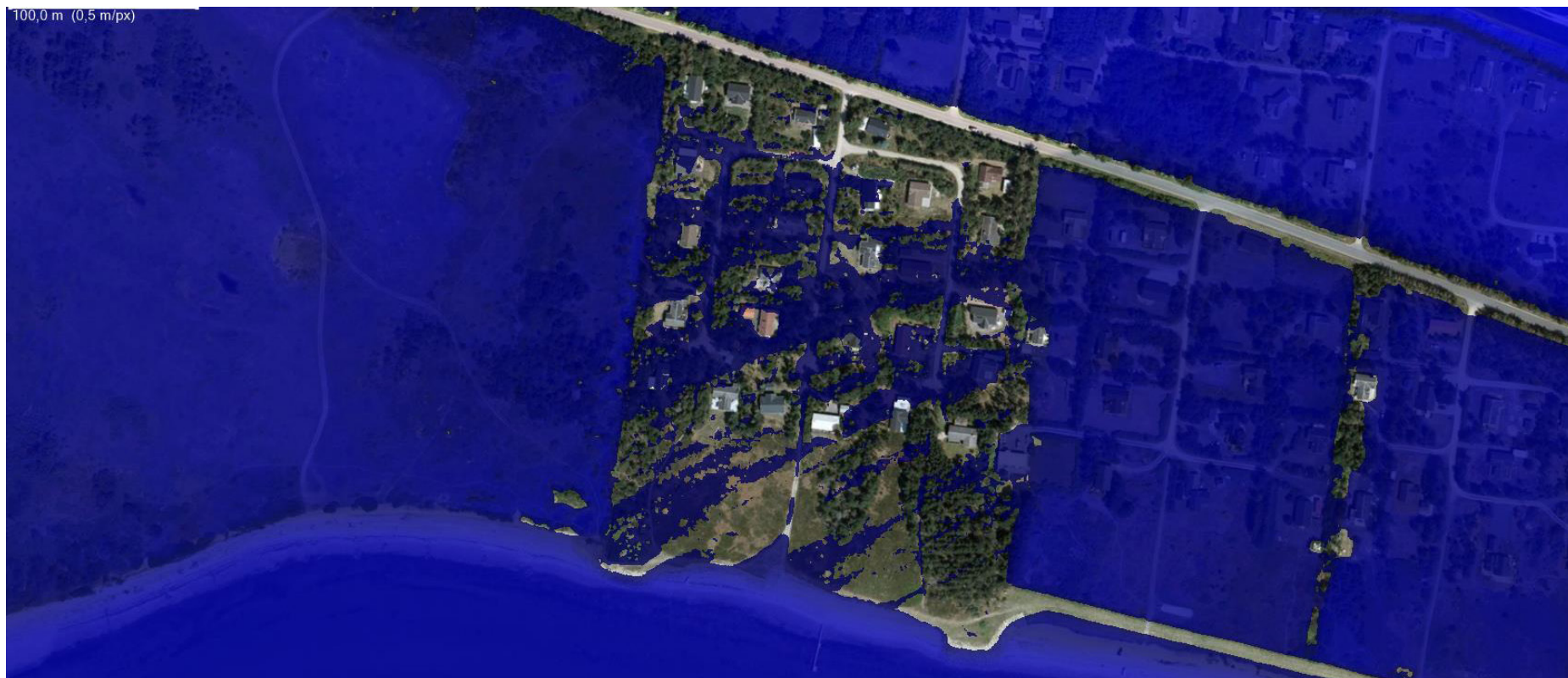
Figur nr. 3 viser oversvømmet areal ved Hættemågevej ved en vandstand på 2,2 m over dvr90. Dvr90 er et referencepunkt for der hvor terræn på land begynder, dvs kote 0.
