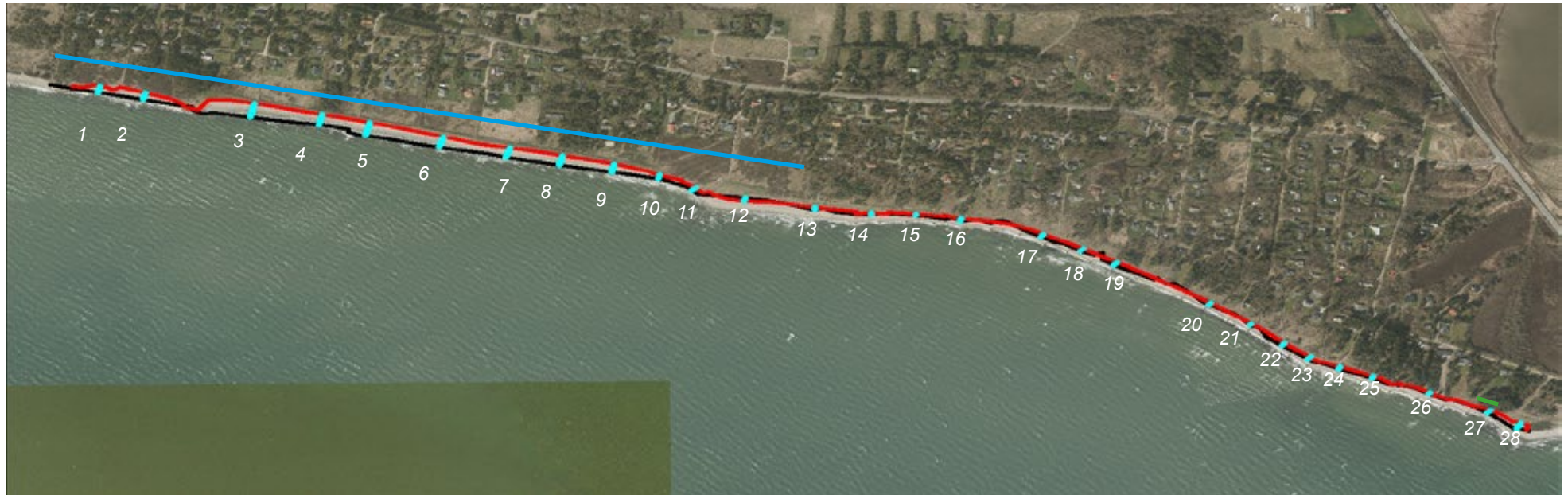
Figur nr. 6 viser kystudvikling imellem 1999 (sort) og 2019 (rød) på ortofoto fra 2019. Blå steg viser projektstrækning
