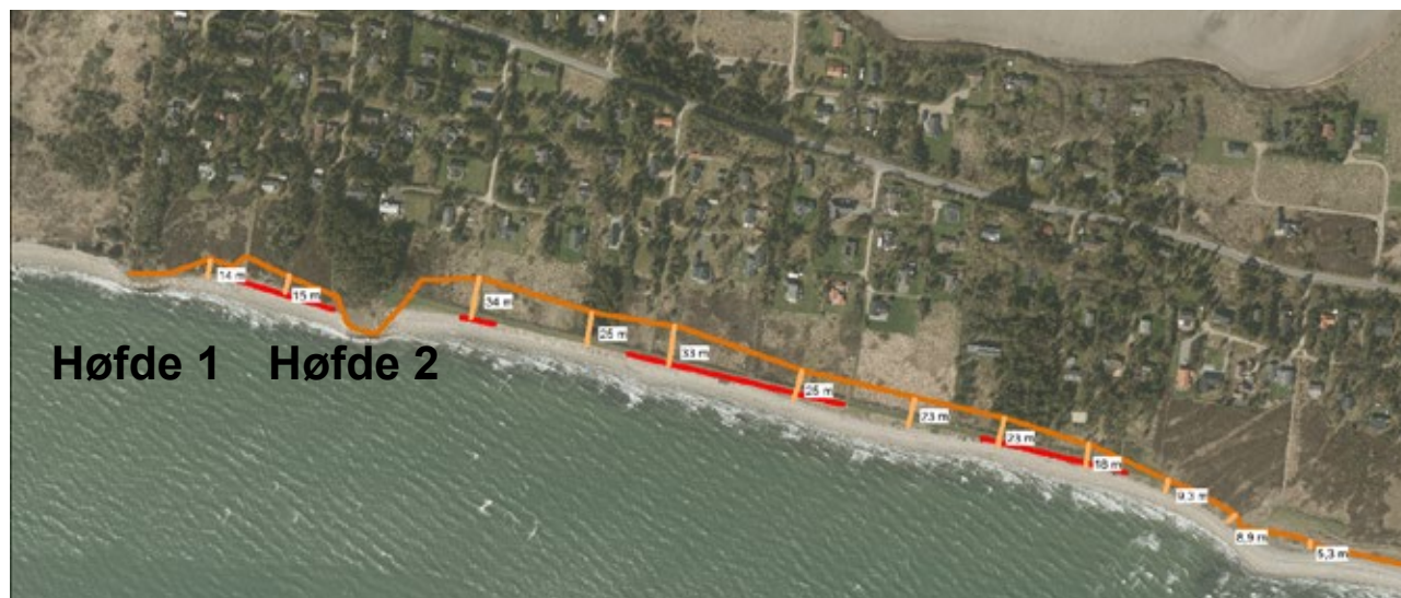
Figur nr. 20 viser et scenarie for kystudviklingen 25 år ud i fremtiden på projektstrækningen, såfremt der ikke foretages noget (nul scenarier). Rød viser strækninger med akut erosion.
