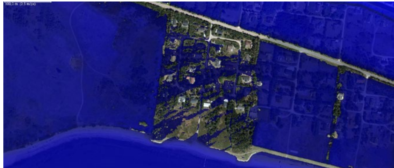
Figur nr. 11 viser oversvømmet areal ved en vandstand på 2,2 m over dvr90
