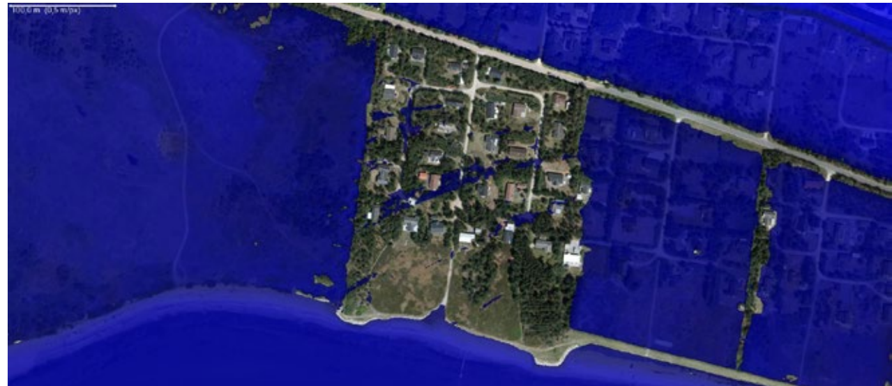
Figur nr. 10 viser oversvømmet areal ved en vandstand på 2,0 m over dvr90
