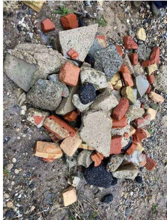
Figur 4 Bunke med byggeaffald samlet på stranden. Tegl, beton, asfalt.
