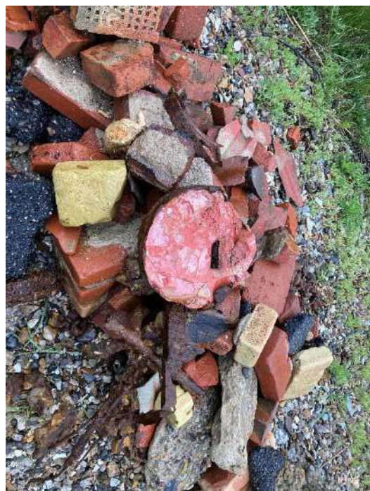
Figur 10 Bunke med byggeaffald samlet på stranden. Tegl, beton, asfalt, metaldele. Uidentificerbar rød affaldsfraktion i toppen.
