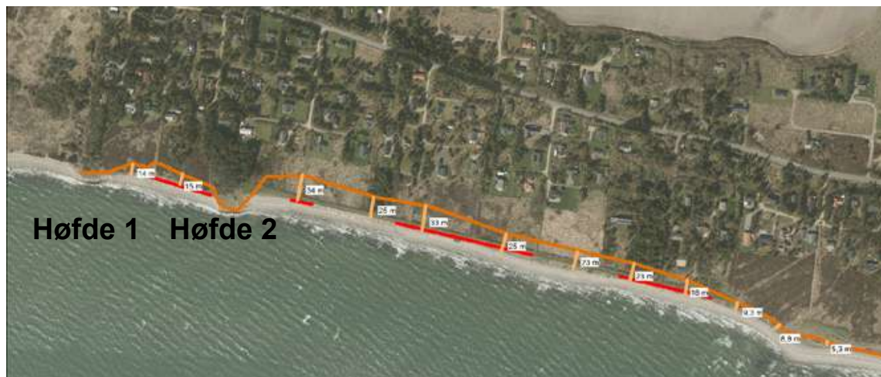
Figur nr. 37 viser et scenarie for kystudviklingen 25 år ud i fremtiden på projektstrækningen, såfremt der ikke foretages noget (nul scenariet). Rød viser strækninger med akuterrosion.
