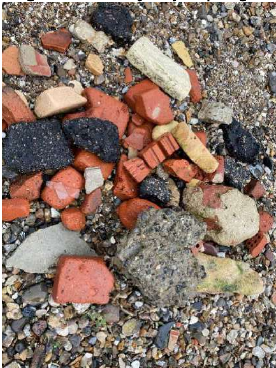
Figur 1 Bunke med byggeaffald samlet på stranden. Tegl, beton, asfalt.
